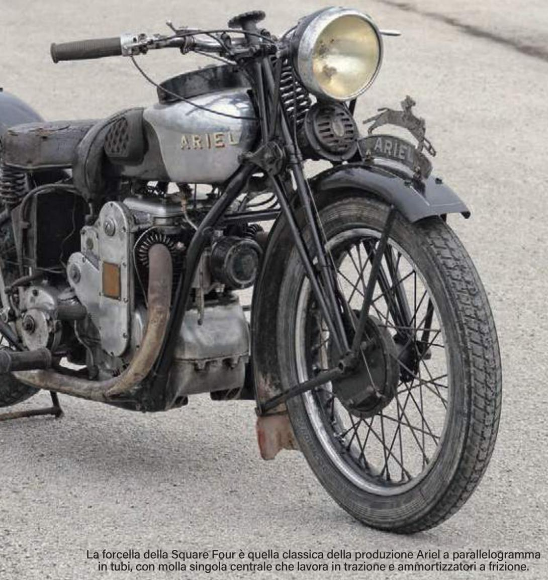
La forcella della Square Four è quella classica della produzione Ariel a parallelogramma in tubi, con molla singola centrale che lavora in trazione e ammortizzatori a frizione.
