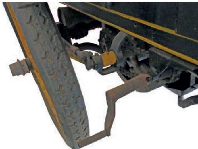
Le ruote erano di legno del tipo molto robusto usato in artiglieria, anche se altri costruttori impiegavano ruote a raggi di derivazione ciclistica. Le prime erano preferibili per la loro superiore durata (come quelle della Itala della Pechino-Parigi del 1907).
