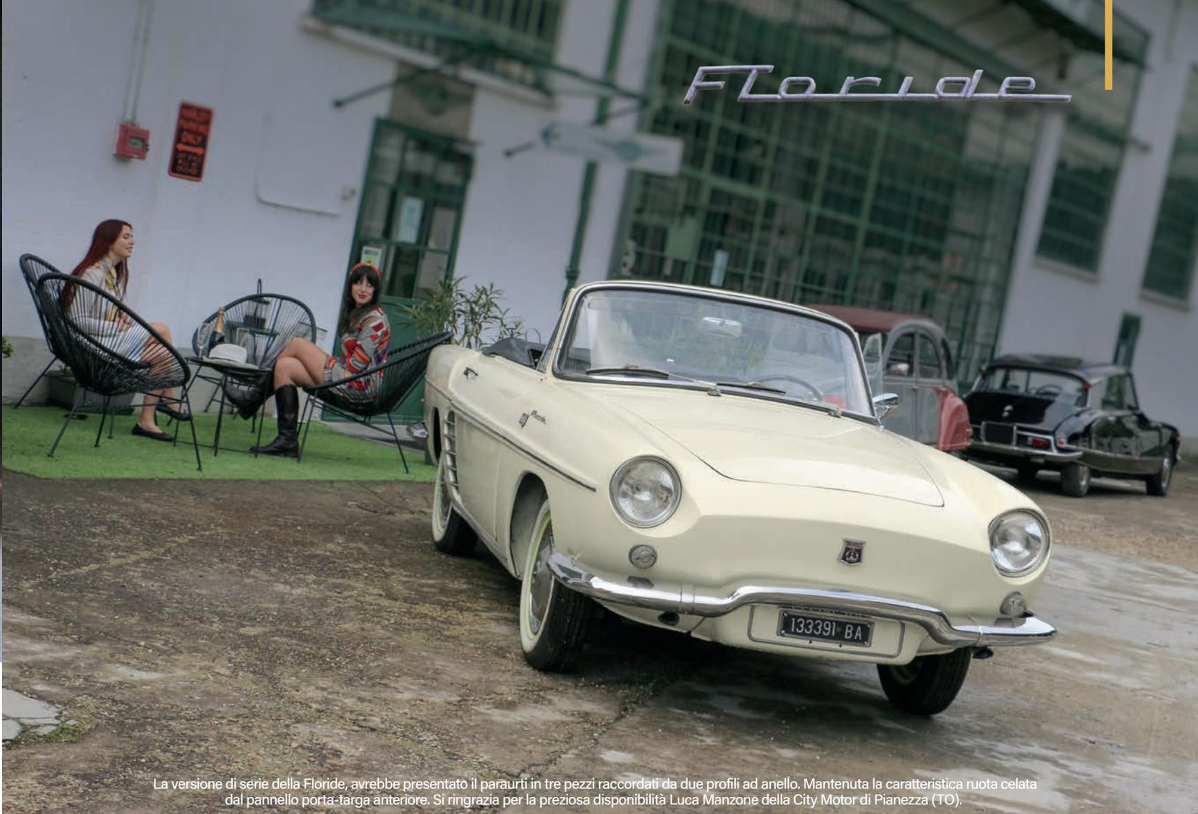
La versione di serie della Floride, avrebbe presentato il paraurti in tre pezzi raccordati da due profili ad anello. Mantenuta la caratteristica ruota celata dal pannello porta-targa anteriore. Si ringrazia per la preziosa disponibilità Luca Manzone della City Motor di Pianezza (TO).
