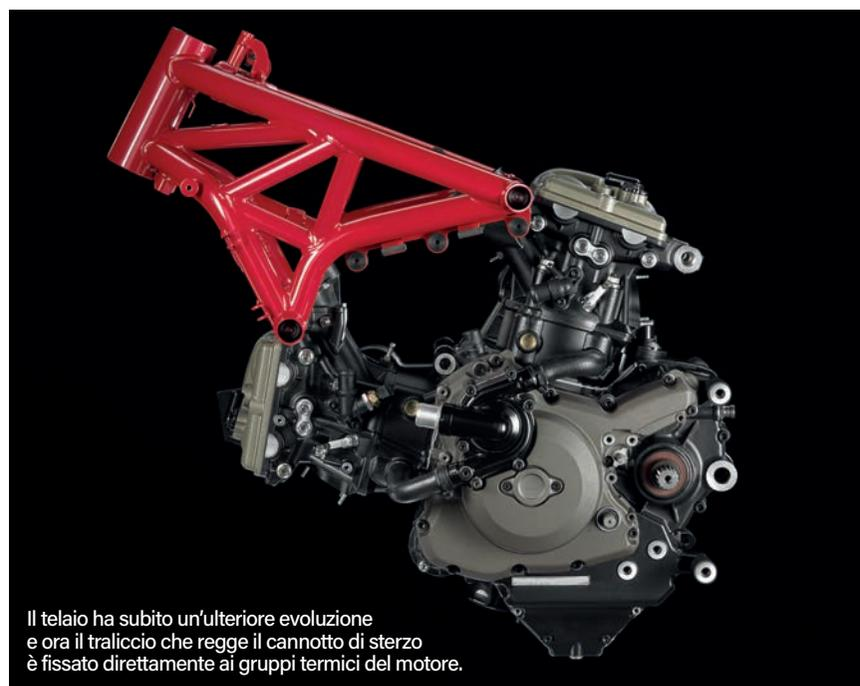
Il telaio ha subito un'ulteriore evoluzione e ora il traliccio che regge il canotto di sterzo è fissato direttamente ai gruppi termici del motore.
