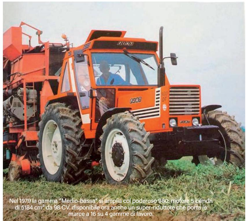
Nel 1979 la gamma "Medio-bassa" si amplia col poderoso 980: motore 5 cilindri di 5184 cm<sup>3</sup> da 98 CV. disponibile ora anche un super-riduttore che porta le marce a 16 su 4 gamme di lavoro.
