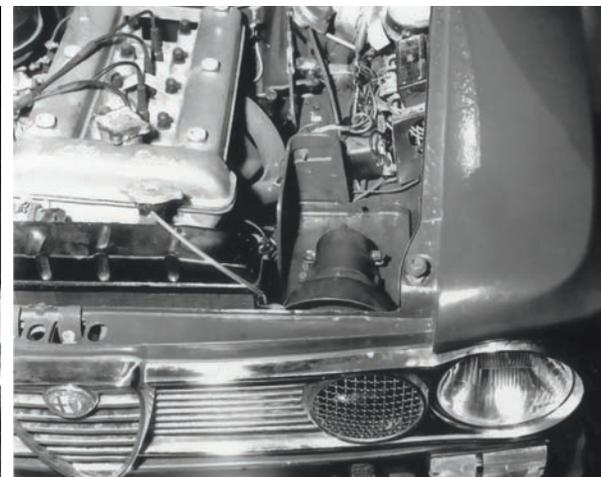
La sirena trova posto nel vano motore a sinistra e diffonde il suo suono tramite una griglia frontale che sostituisce entrambi i fari di profondità normalmente presenti sulle Giulia civili. Nel cofano trova posto la centralina dell'impianto radio direttamente collegata alle Centrali Operative.
