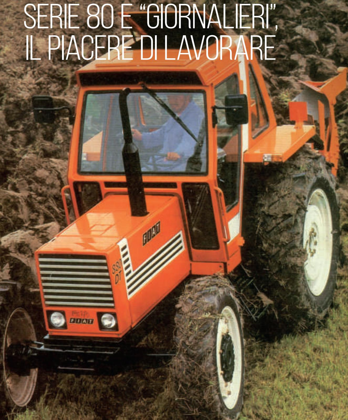
Un 880 DT (Doppia Trazione) con cabina Superconfort disegnata da Pininfarina che esordisce nel 1978: anziché a filo, la lamiera d'acciaio è saldata a punti come sulle auto, perciò è una monoscocca a tutti gli effetti. Sarà il modello più richiesto in Europa.
