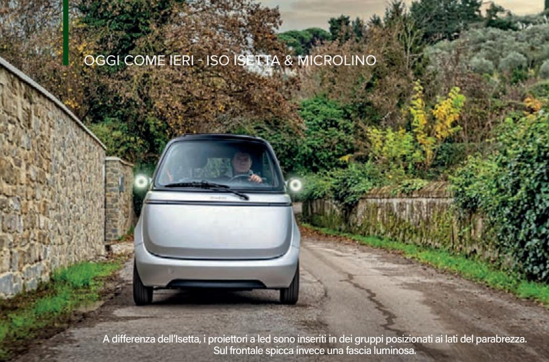
A differenza dell'Isetta, i proiettori a led sono inseriti in dei gruppi posizionati ai lati del parabrezza. Sul frontale spicca invece una fascia luminosa.
