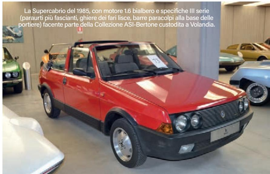
La Supercabrio del 1985, con motore 1.6 bialbero e specifiche III serie (paraurti più fascianti, ghiera dei fari lisce, barre paracolpi alla base delle portiere) facente parte della Collezione ASI-Bertone custodita a Volandia.
