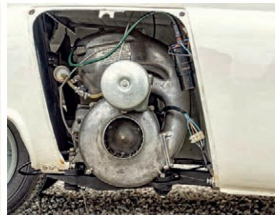
Sopra, da sinistra, le caratteristiche tecniche del propulsore - con il tipico cilindro sdoppiato - e il sistema di boccole in gomma applicate al telaio. Il propulsore monocilindrico a due tempi Iso di 236 cm<sup>3</sup>, derivato dal 198 dello scooter Iso 200. Anche la Microlino (sotto) è caratterizzata dal portellone frontale.
