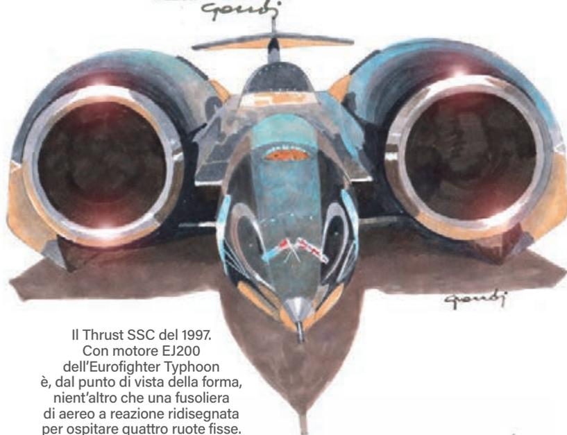
Il Thrust SSC del 1997. Con motore EJ200 dell'Eurofighter Typhoon è, dal punto di vista della forma, nient'altro che una fusoliera di aereo a reazione ridisegnata per ospitare quattro ruote fisse.
