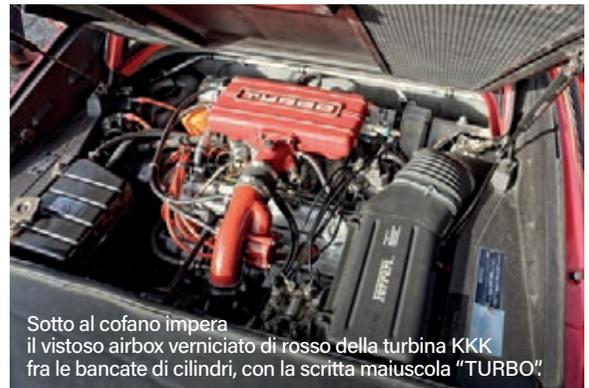
Sotto al cofano impera il vistoso airbox verniciato di rosso della turbina KKK fra le bancate di cilindri, con la scritta maiuscola "TURBO".
