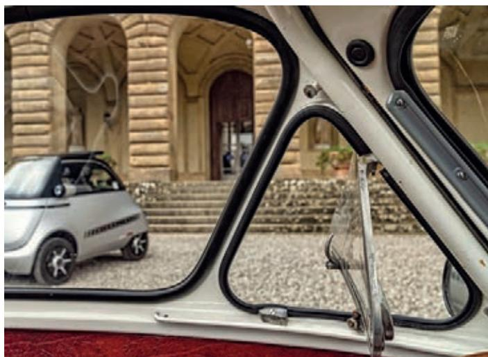
La ventilazione dell'abitacolo è garantita dal deflettore triangolare. Nei disegni di Michelotti appariva un vetro singolo, che non si potette mantenere a causa degli elevanti costi di produzione.
