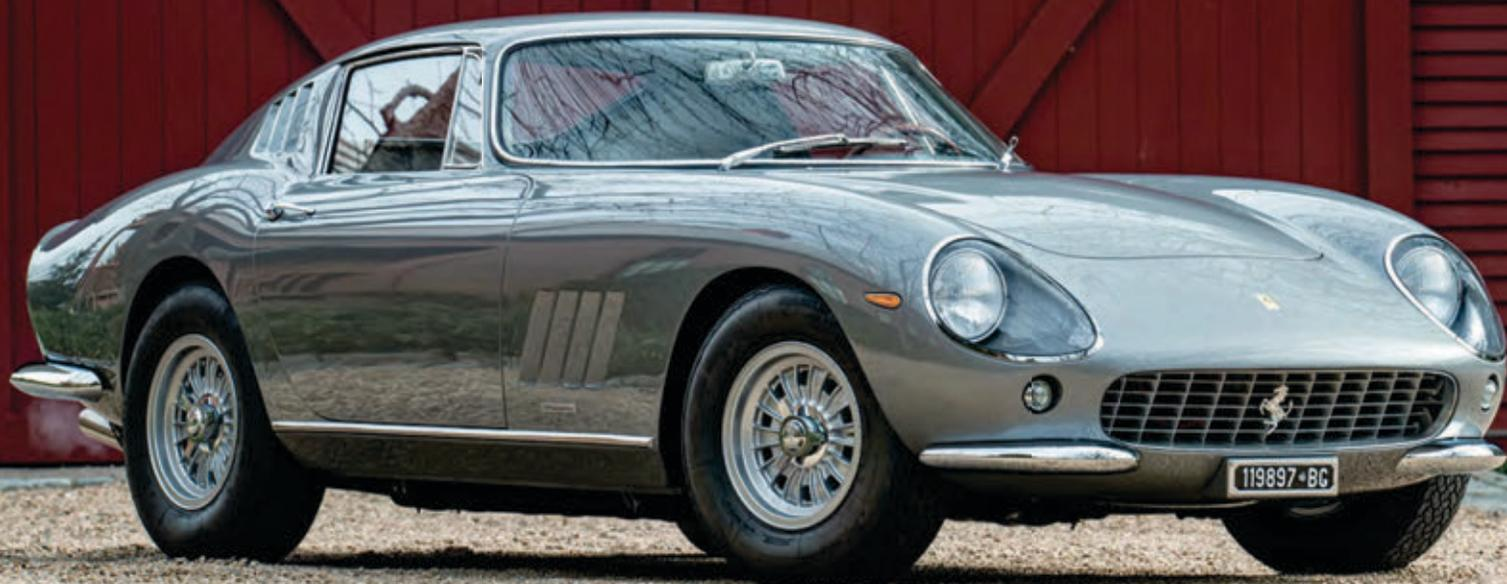
La 275 GTB allestita nel 1965 sul telaio Tipo 563 numero 6899 appartiene alla Serie 1, distinta dal "muso corto", dalla "bocca larga", dai cerchi in lega con le nervature radiali, da un solo serbatoio del carburante e dal motore con il carter umido.
