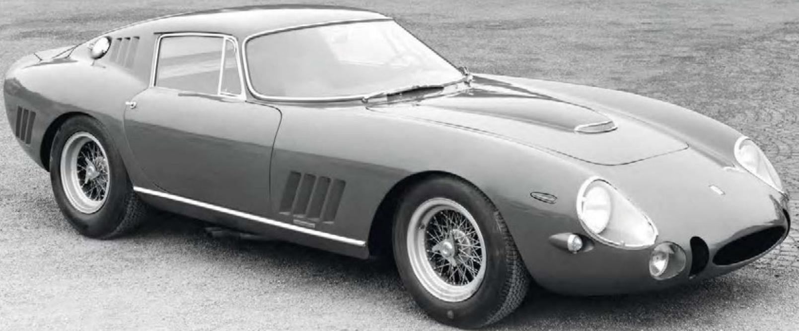
La magnifica 275 GTB/Competizione Speciale allestita sul telaio # 06885 GT ha il muso con le prese d'aria di foggia e disposizione particolari, il cofano più basso e affusolato, la bugna che cela i sei carburatori e il tappo di rifornimento rapido sul montante posteriore.
