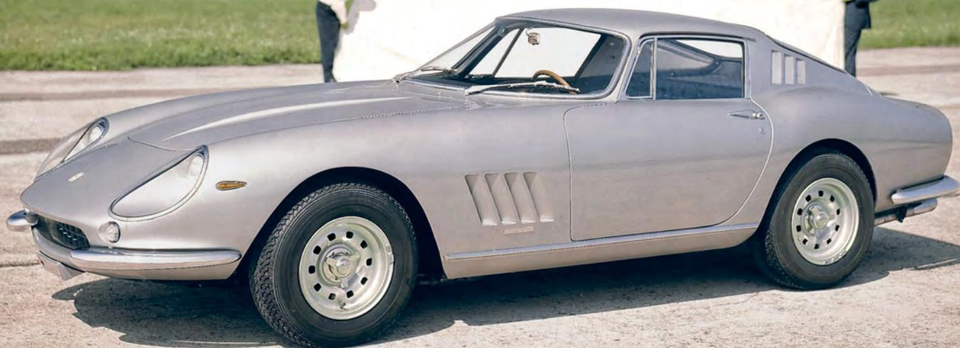
La 275 GTB/4 fotografata a Modena per la manualistica. Nella sostanza, la carrozzeria è quella delle 275 GTB "muso lungo", le vere novità sono il motore con quattro alberi e il tubo che collega rigidamente il propulsore con il gruppo cambio/differenziale.
