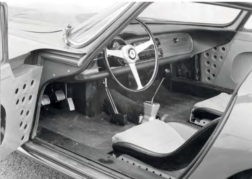
L'interno di selvaggia bellezza della 275 GTB Competizione Speciale telaio # 06885 GT conserva solo la plancia del modello di serie, le finiture di tutto il resto sono semplificate al massimo per ridurre il peso e le porte prive di cartelle lasciano in vista i fori sulle lamiere.
