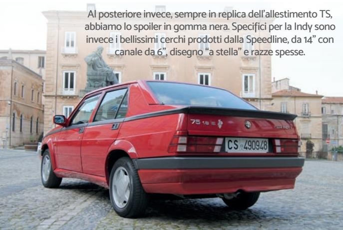
Al posteriore invece, sempre in replica dell'allestimento TS, abbiamo lo spoiler in gomma nera. Specifici per la Indy sono invece i bellissimi cerchi prodotti dalla Speedline, da 14" con canale da 6", disegno "a stella" e razze spesse.
