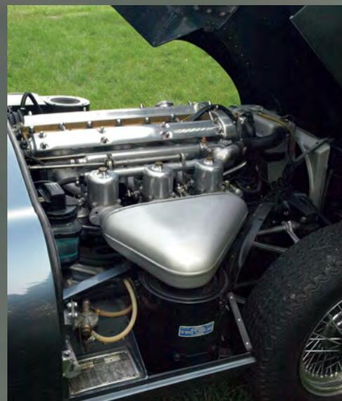
ne dal posto di guida. Bill Wilkinson sta nel frattempo apportando modifiche al motore 3,4 l (quello della XK 150), rendendolo meno alto. Tolta dal regolamento della 24 Ore di Le Mans la limitazione a 3 litri di cilindrata, si arriva quindi a pensare di adottare un motore di 3781 cm<sup>3</sup>, sempre 6 cilindri in linea, doppio albero a camme in testa, 3 carburatori Stromberg SU HD8, da 265 CV, sia per la XK 150, oramai in fine produzione, che per la nascente E-Type.
