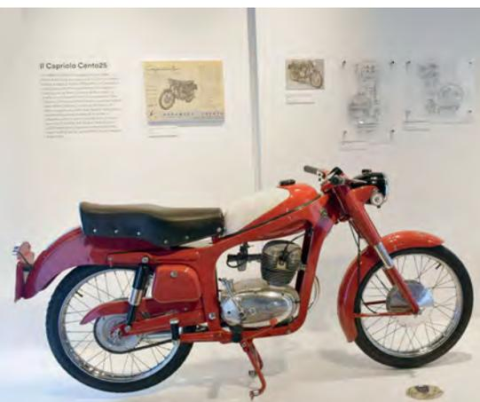
La Aeromere Cento25 è il modello che nel 1956 segna il passaggio di consegne tra la Aero Caproni e la Aeromere, anche se il progetto è ancora Aero Caproni, di cui la moto conserva il tipico telaio in lamiera stampata a doppia culla. Il motore è nuovo: monocilindrico a 4 tempi con albero motore trasversale e distribuzione ad albero a camme in testa. Alesaggio e corsa 55 x 52 mm, potenza 7,5 CV a 6.000 giri/min, Ruote da 19", velocità massima 95 km/h.
