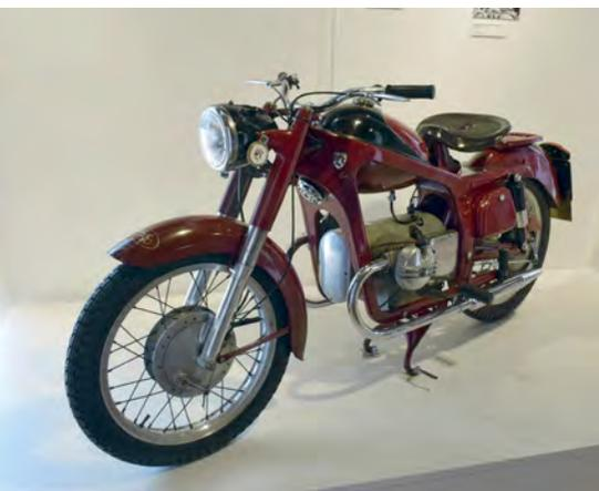
La Cento50, presentata nel 1953 e prodotta dal 1954 al 1956, non ottiene lo stesso successo commerciale degli altri modelli a causa del costo elevato. Il motore bicilindrico a cilindri contrapposti gli consente di raggiungere la velocità massima di 100 km/h con consumo medio di 1 l/42 km. Le ruote sono da 17" e i primi esemplari commercializzati hanno la forcella "tipo Earles" e l'alimentazione a due carburatori.
