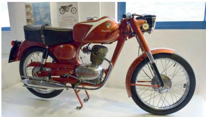
Nel 1961 la Aeromere amplia la gamma delle cilindrate con la 100 offerta in versione Turismo e Sport, quest'ultima chiamata ufficialmente Bondone in onore dei successi ottenuti dalle moto trentine nell'omonima corsa in salita. Motore monocilindrico, alesaggio e corsa 54x43 mm, 6 CV a 6.000 giri/min, ruote da 19", velocità massima 90 km/h, consumo 1/55 km. 2500 prodotte (100 totali).
