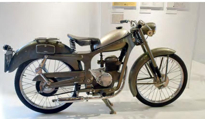
La Aero Caproni fa il suo esordio nel settore moto col Capriolo 75 a inizio 1952. Motore monocilindrico 4 tempi, alesaggio e corsa 47 x 43 mm, albero motore longitudinale e distribuzione a valvole in testa comandate da camma a tazza, 3,5 CV a 6.000 g/m. Alimentazione a carburatore Dell'Orto da 15 mm, cambio a 4 marce, velocità massima 75 km/h, consumo dichiarato 1l/65 km.
