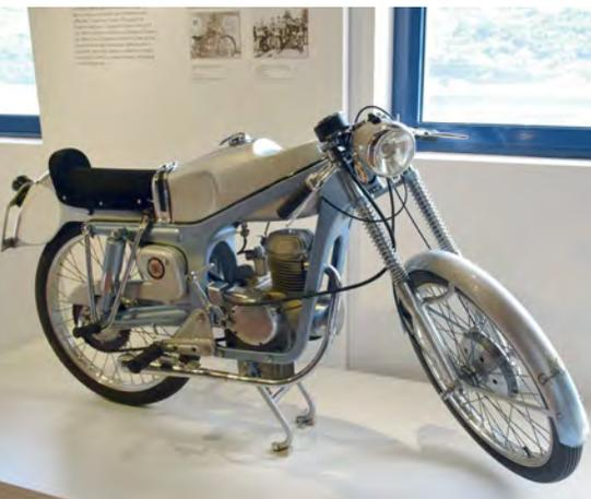
Il 75 Corsa è sicuramente il modello più ambito della gamma Capriolo. Derivato dalla versione Sport è caratterizzato dal notevole incremento delle prestazioni, con ben 8,2 CV a 9.800 giri. Il cambio è a 5 rapporti e la velocità massima di 115 km/h. Il peso è di 70 kg e le ruote con i cerchi in lega leggera sono da 20". Oltre che alle competizioni dal 1954 al '57 la Aero Caproni si è rivolta anche al trasporto utilitario con i motocarri Microcar 75 e Cento 50.
