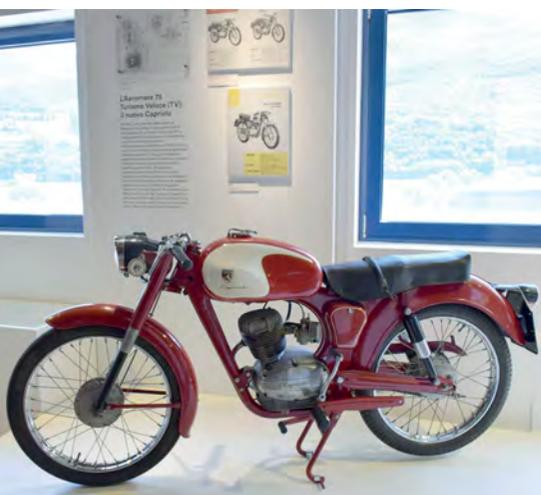
La svolta definitiva tra la produzione Aero Caproni e Aeromere la si ha nel 1958 con la presentazione della 75 TV, subito identificata come la "nuova Capriolo". Il motore riprende le soluzioni già collaudate sulla Cento25, pur mantenendo alesaggio e corsa di 47 x 43 mm. Il telaio, inedito, è un monotrave formato da due gusci di lamiera stampata saldati sul piano longitudinale. Le ruote sono da 19", la velocità massima tocca i 90 km/h e il consumo è di 1/62 km.
