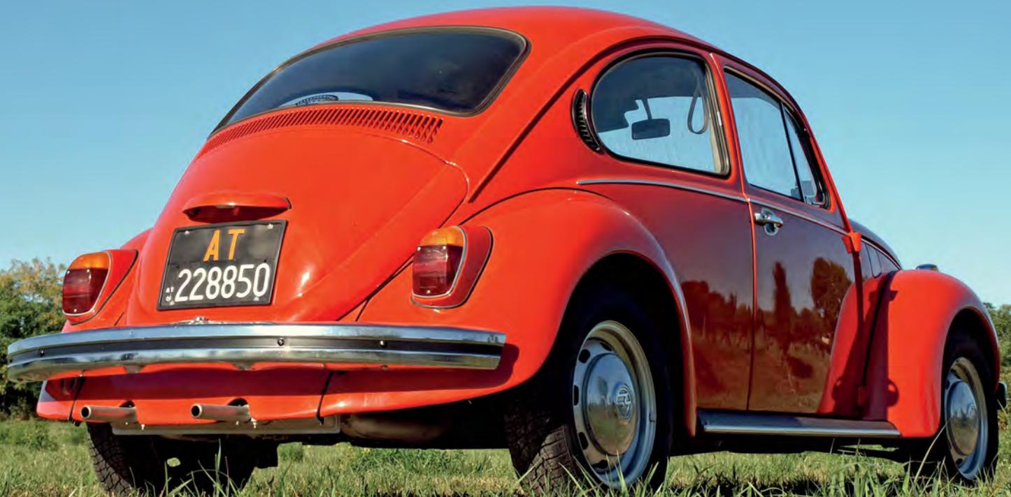
I tipici fanali posteriori, con forma a “ferro da stiro”, rimarranno così fino al 1973. Migliorata anche la ventilazione interna grazie a due nuove prese d'aria poste dietro ai finestrini posteriori che, unite alla ventilazione anteriore con ventola elettrica optional, permettevano un buon ricircolo e ricambio di aria nell'abitacolo.
