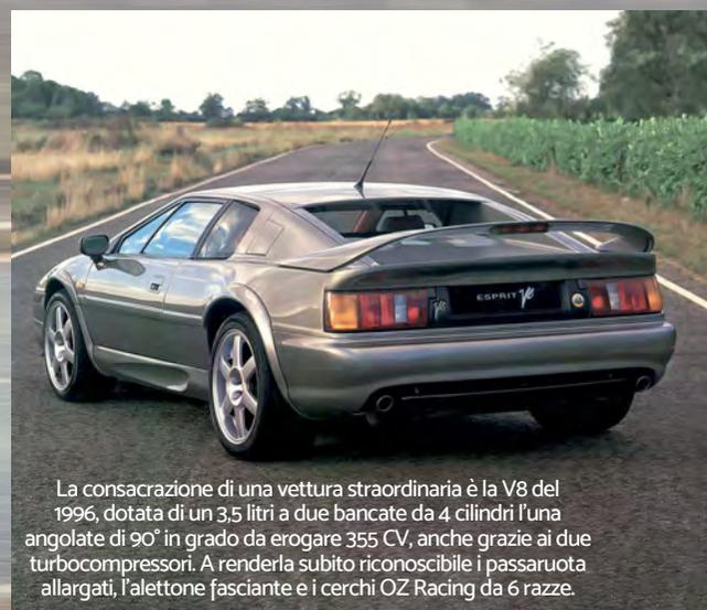
La consacrazione di una vettura straordinaria è la V8 del 1996, dotata di un 3,5 litri a due bancate da 4 cilindri l'una angolate di 90° in grado di erogare 355 CV, anche grazie ai due turbocompressori. A renderla subito riconoscibile i passaruota allargati, l'alettone fasciante e i cerchi OZ Racing da 6 razze.
