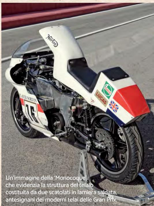
Un'immagine della 'Monocoque' che evidenzia la struttura del telaio costituita da due scatolati in lamiera saldata, antesignani dei moderni telai delle Gran Prix.
