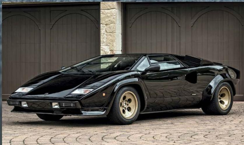
La LP500S. Tranne qualche modifica alla plancia, mantiene le caratteristiche estetiche della LP400S terza serie. La novità è sotto il cofano: il motore che torna alla primitiva potenza di 375 CV con la cilindrata maggiorata a 4754 cm<sup>3</sup> e altri ritocchi.
