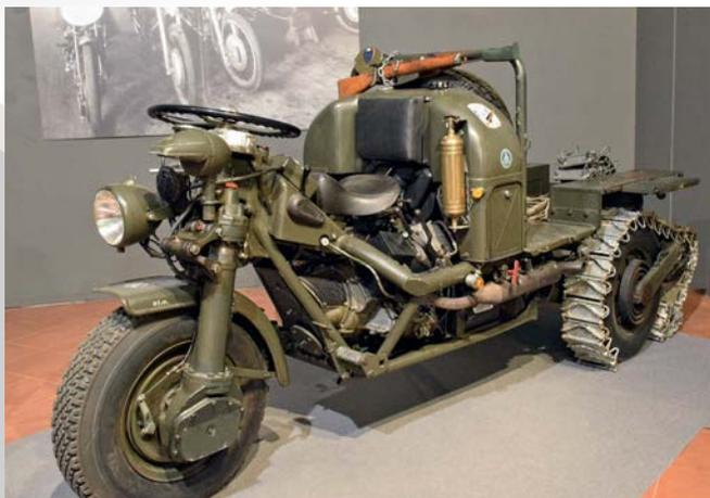
Il caratteristico "Mulo Meccanico" per l'Esercito: cingolabile, prima Moto Guzzi a essere equipaggiata con il motore bicilindrico a V di 90°, è utilizzata per il trasporto dei muli nei reparti alpini.
