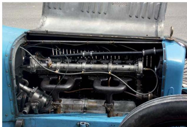
Le due finestrelle sul coperchio motore destro, per accedere ai carburatori rapidamente. Il magnifico 8 cilindri in linea bialbero con 4 valvole per cilindro in testa, progettato da Henry, ex Peugeot: il motore di 3 litri infatti, non è niente altro che l'accorpamento di due blocchi a 4 cilindri, lo si nota dai due gruppi di condotti di scarico.
