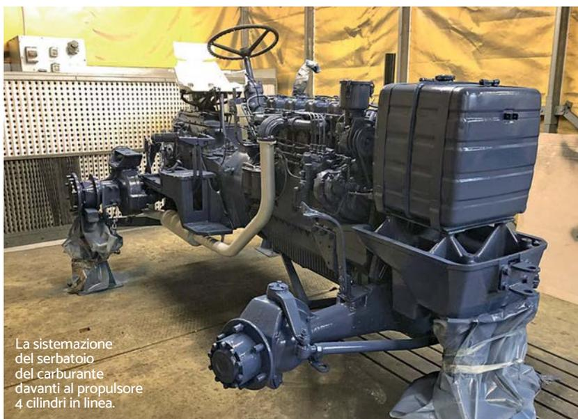
La sistemazione del serbatoio del carburante davanti al propulsore 4 cilindri in linea.
