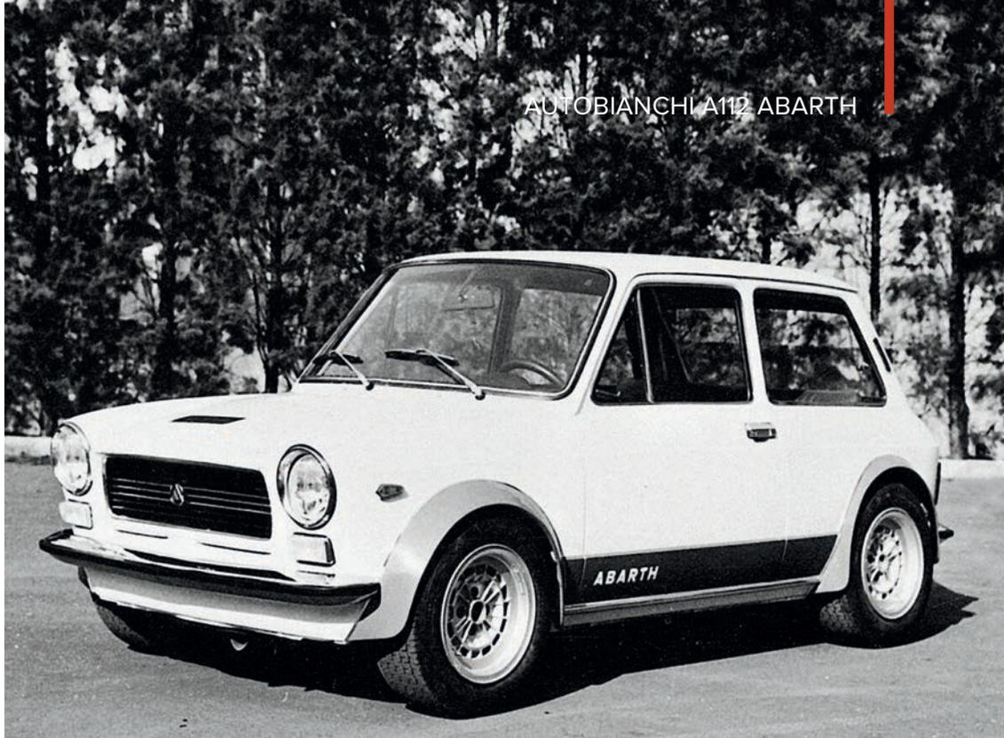
Il prototipo iniziale elaborato da Abarth con motore radiale da 108 CV e forte caratterizzazione estetica (fasce laterali, ampi codolini per ospitare ruote 4,5/10.00x13" con cerchi Campagnolo a canale maggiorato).
