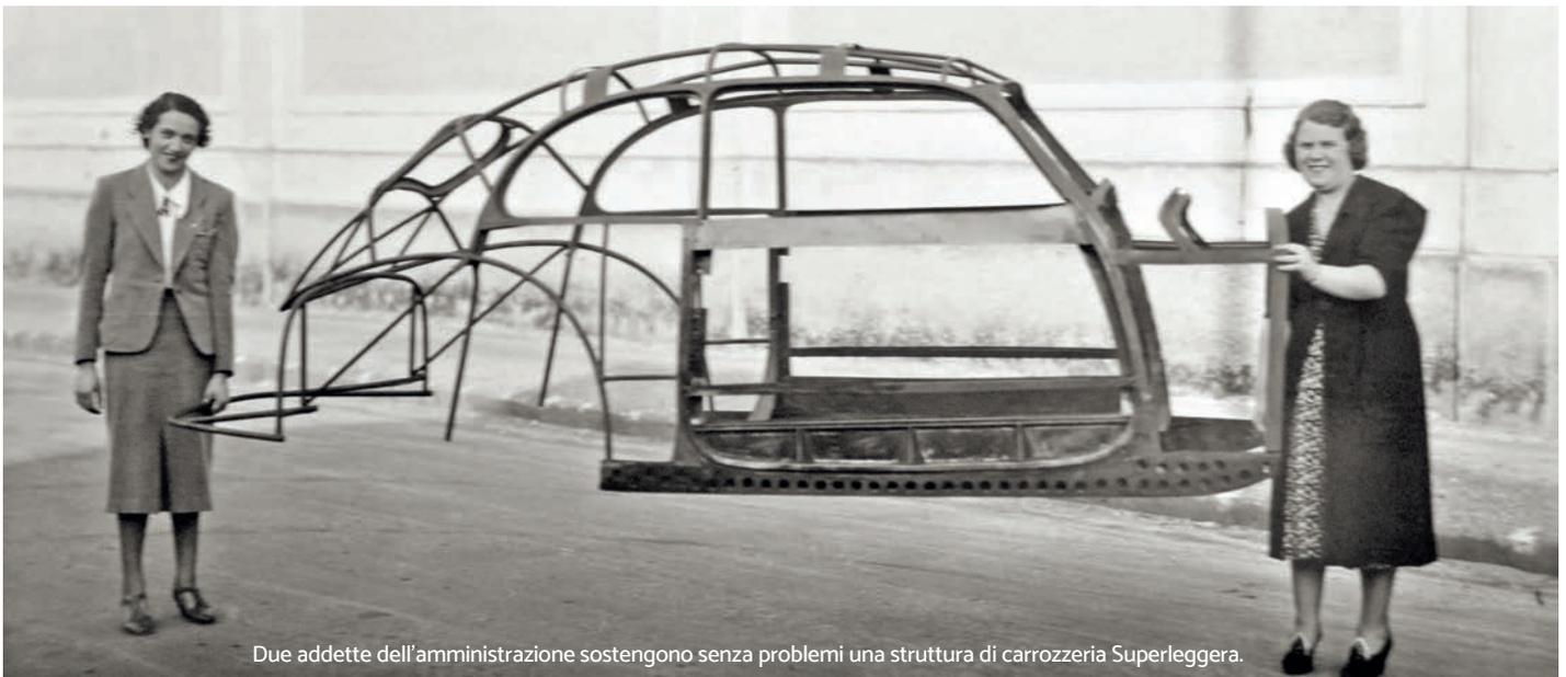
Due addette dell'amministrazione sostengono senza problemi una struttura di carrozzeria Superleggera.
