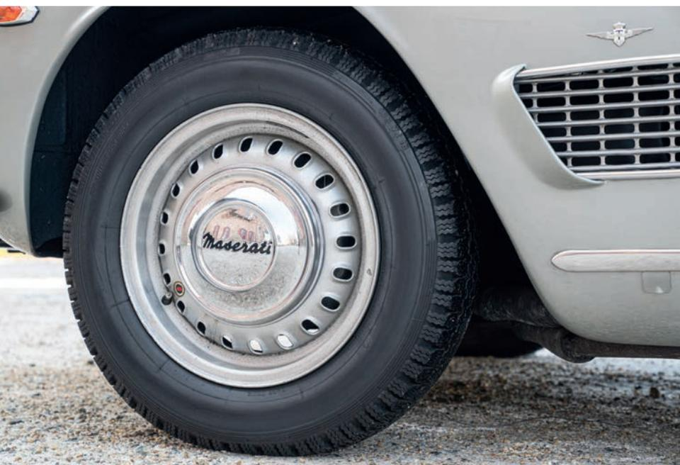
I cerchi Borrani a 20 feritoie da 16" sono fra gli elementi caratteristici del modello, molto grandi per l'epoca. Erano disponibili anche le ruote a raggi ma furono scelte da pochissimi clienti. Gli interni riprendono il bellissimo disegno del prototipo, col caratteristico maniglione che a centro plancia si raccorda con la mensola.
