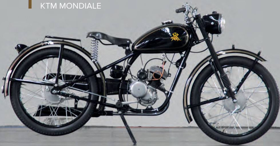
Una delle prime KTM R 100 dette "Moser", riconoscibile dallo stemma con la tigre. Monta il motore Rotax Typ L 98 di 98 cm 3 che ha la potenza di 3 CV, l'avviamento a strappo e il cambio a due marce con comando sul manubrio.
