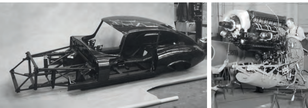
Gli Interni della Jaguar E Type Fixed Head del 1961. Per la forma dei sedili i progettisti si sono lasciati ispirati dai caccia Supermarine Spitfire. Sotto, il Castello motore e la scocca. Una soluzione costruttiva robusta, leggera e di facile produzione: in altre parole un capolavoro. Il motore di un Supermarine Spitfire mentre viene montato sul castello motore imbullonato sul paraframma.
