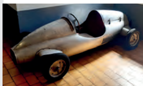
MONOPOSTO FATTA A MANO IN ALLUMINIO , ruote scoperte, motore 125cc Lambretta, telaio tubolare FCB, ESEMPLARE UNICO. COSTRUITA NEL 1954 !
