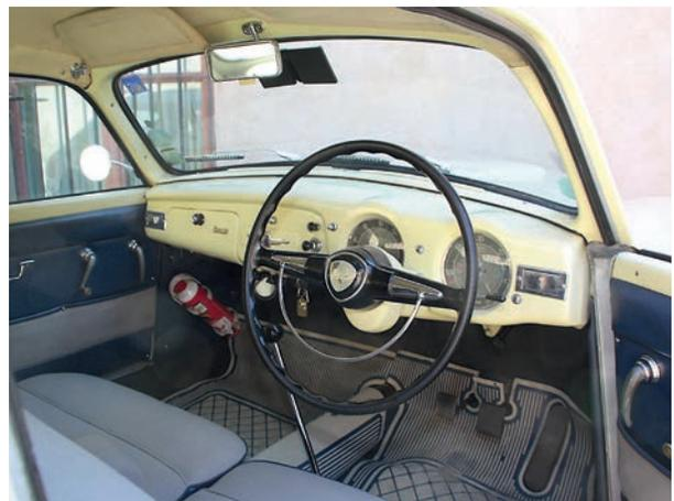
Elegantissima e di fattura estremamente raffinata la grafica degli strumenti: entrambi sono "scalati" ("x100" il contagiri, "x10" il tachimetro) per uniformare le cifre, poste su una corona esterna in rilievo rispetto al piano delle grandi lancette, trasparenti, per permettere la lettura degli indicatori secondari. Altra finezza: il cofano posteriore si apre agendo su uno dei due gusci ospitanti le luci targa.
