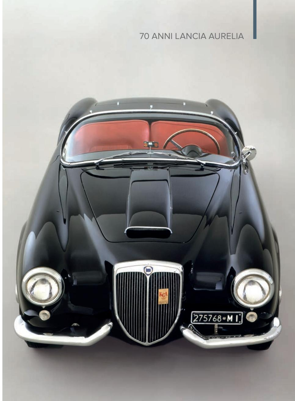
Al posto dei rostri del prototipo invece, appaiono i paraurti con le caratteristiche "corni" (anche al posteriore). Sotto, una B24S Convertibile con Hard Top per una brochure dell'epoca.
