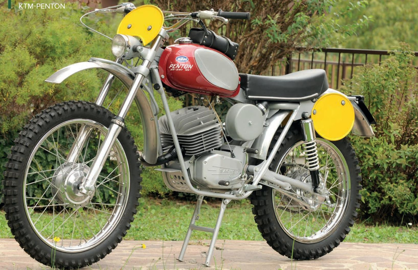
La KTM-Penton Six Day 125 nella versione 1970-71. Il motore Sachs 125 monta un nuovo gruppo termico col cilindro in lega leggera e la testa con l'alettatura radiale.
