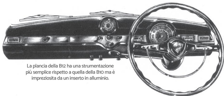
La plancia della B12 ha una strumentazione più semplice rispetto a quella della B10 ma è impreziosita da un inserto in alluminio.
