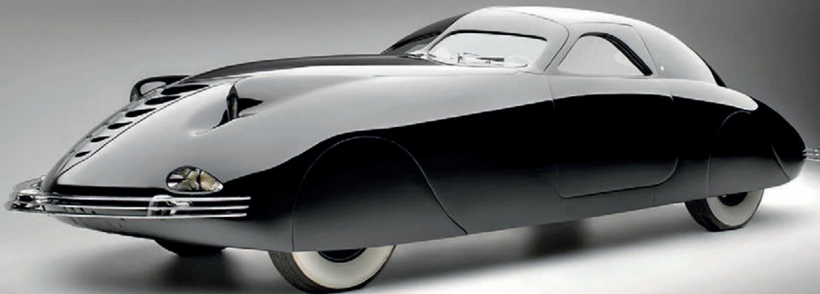
Il prototipo Phantom Corsair disegnato da Rust Heinz e Maurice Schwartz nel 1938 e realizzato sul telaio della Cord 810, estremizza il concetto di Streamline, permettendo alla vettura, dotata del V8 Lycoming dal 190 CV della Cord, una velocità massima di 185 km/h.
