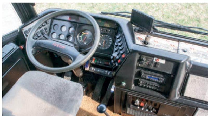
Il posto guida, completo di ogni comando per il controllo della marcia e dei servizi di bordo. Sotto i comandi per l'apertura delle porte si riconosce il comando del retarder.
