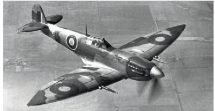
L'ala di forma ellittica presenta un profilo abbastanza sottile ma è sufficientemente capiente per contenere le otto mitragliatrici Browning 303 e il carrello retratto. Ed è proprio per il notevole contenuto dell'ala che i serbatoi del carburante devono essere collocati in fusoliera, tra il motore e il posto di pilotaggio.
