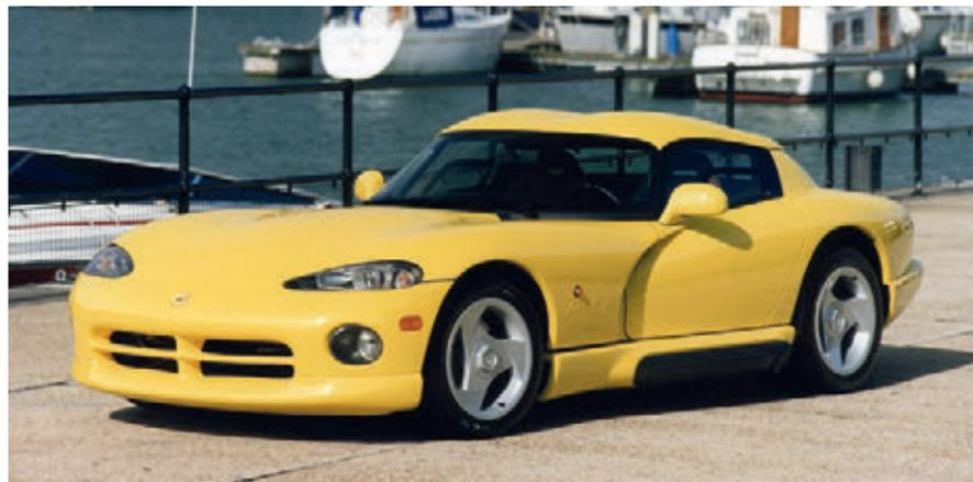
La fiancata è dominata dalla volumetria del cofano che finisce nel grande svaso prima della portiera che funge da presa d'aria. Altri elementi caratterizzanti sono le minigonne che inglobano i terminali di scarico e l'assenza di maniglie. A destra, un esemplare di roadster con hard top. La copertura dell'abitacolo è altrimenti possibile con uno stringatissimo pannello in tela, poco impermeabile, come nelle Targa del passato.
