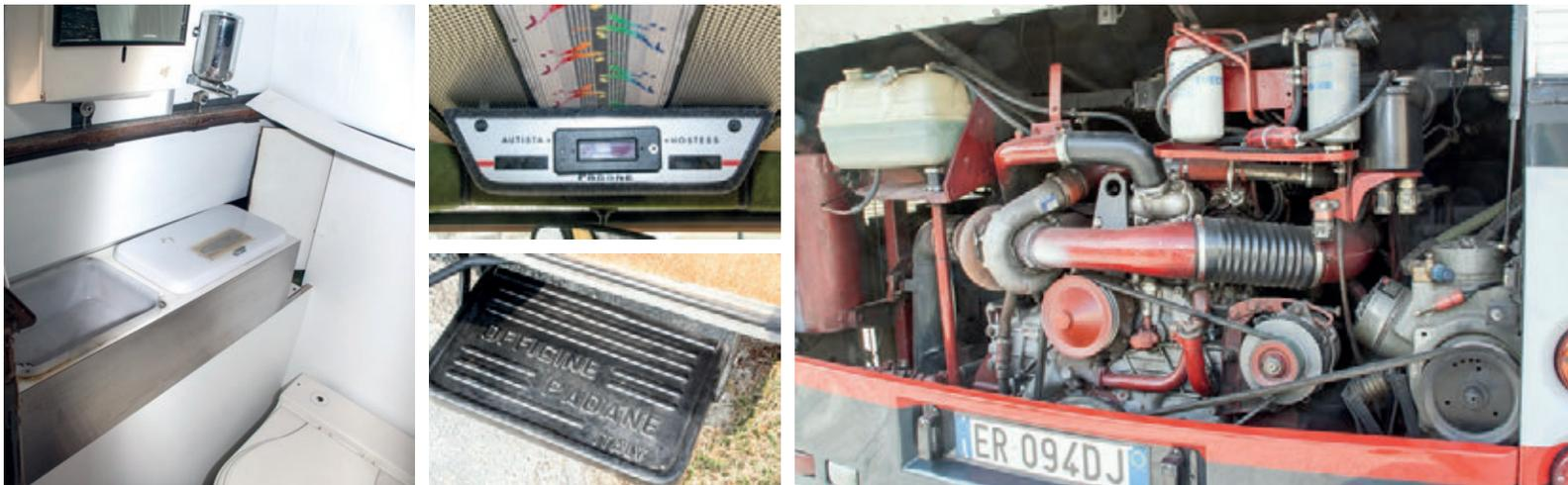
Sopra, a sinistra, la toilette. Al centro, gli indicatori dell'impianto altoparlante e l'orologio digitale. Il predellino per la porta anteriore. A destra, il motore di 13,8 litri turbocompresso da 304 CV. Sotto, la strada è ovviamente il suo terreno ideale. Nello specchio di coda si può ammirare la livrea tipica della Padane dell'epoca e i "servizi di bordo" elencati sull'ampio vetro posteriore.
