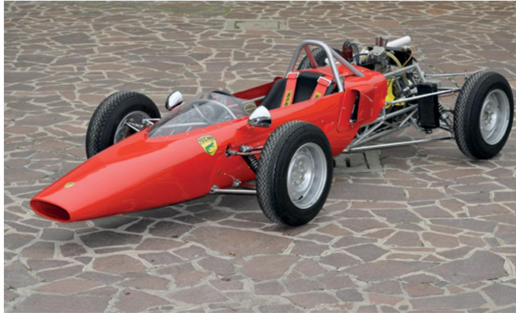
La monoposto Tecno è caratterizzata dalla posizione di guida molto avanzata. La carrozzeria è decisamente essenziale e ridotta al minimo, anche per limitare il peso complessivo della vettura.
