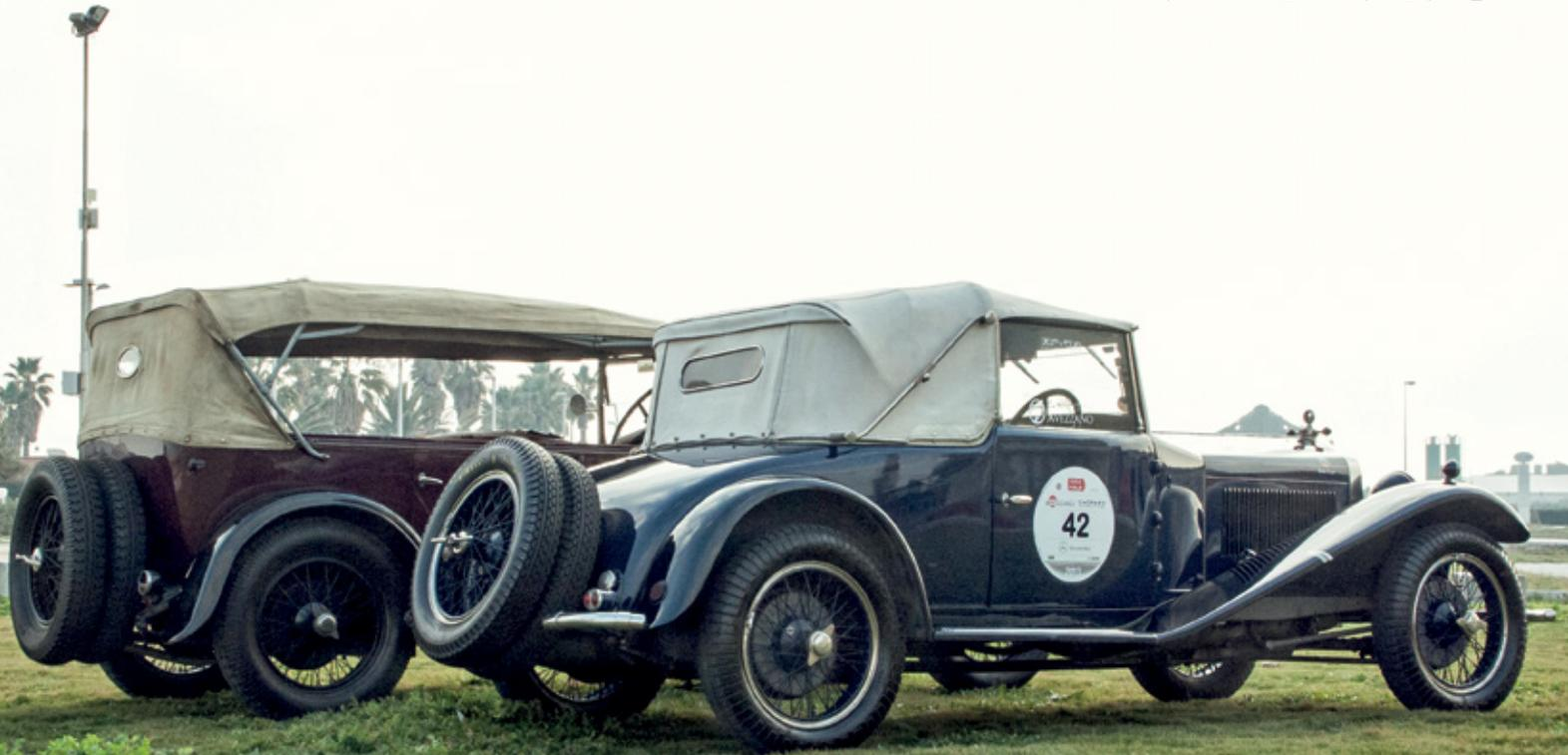
Le viste con le capote alzate: risultano una elegante torpedò e una grintosa spider-cabriolet anche in configurazione chiusa. Il piccolo lunotto ovoidale molato della 1500 era tipico dell'epoca, mentre quello rettangolare della 1750 una novità.
