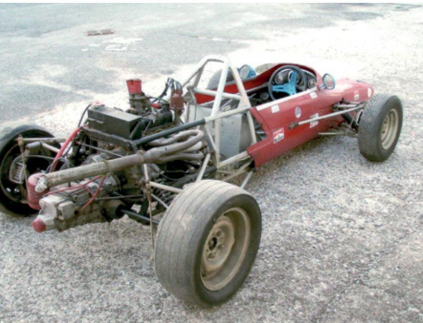
La monoposto di Formula 850 in dettaglio: la sospensione anteriore, il posto di guida che lascia intavvedere il telaio in traliccio di tubi, il carburatore verticale, la punzonatura del telaio con il numero "001", la sospensione ed il freno posteriore, il convogliatore dell'aria sulla fiancata.
