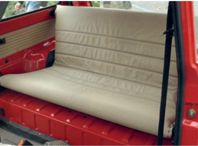
A sinistra, la panca posteriore, si può notare l'assenza del rivestimento di copertura del pianale del bagagliaio, immediatamente sotto al sedile, caratteristica tipica delle Panda30 prodotte fino a circa la metà del 1981. A destra, il sedile in configurazione "culla", utile, all'epoca, per i bimbi più piccoli e per trasportare materiale fragile.
