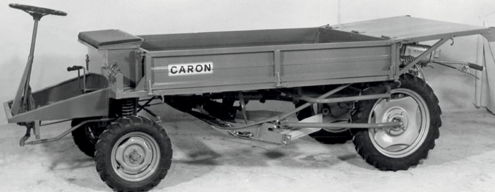
ABBIAMO SCOVATO UN MEZZO DAVVERO CURIOSO, UN MULETTO IN GRADO DI ABBINARSI A UNA MOTOFALCIATRICE BCS DIVENTANDO MEZZO A 4 RUOTE PER IL TRASPORTO FUORISTRADA LEGGERO ED EFFICACE. È UN BREVETTO DELLA CARON, AZIENDA ANCORA OGGI FOCALIZZATA SU MEZZI SPECIFICI PER L'AGRICOLTURA, SPECIALMENTE DI MONTAGNA
