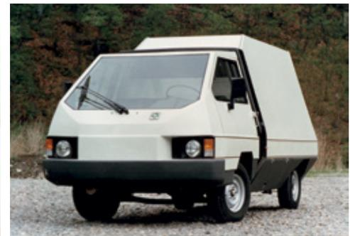
apposite dime la struttura della carrozzeria, che veniva poi rivestita, verniciata, completata di ogni altro organo, per uscire finita e funzionante, con la possibilità - se necessario - di una produzione di circa venti esemplari al mese con una decina di addetti. Naturalmente si avvaleva di gruppi meccanici di grande serie della produzione Fiat per freni, sospensioni, sterzo, ruote, maniglie e piccola componentistica. Efficienza massima, per il miglior risultato!
