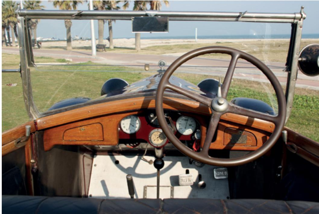
L'abitacolo è semplice ma ben rifinito, con strumentazione completa e leggibile. L'acceleratore è centrale, a chiodo, sui pedali di frizione e freno ci sono le scritte “Alfa” e “Romeo”.
