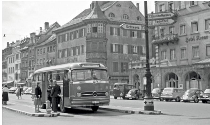
Un O 321 H in configurazione urbana con portiere a soffietto. Sotto, in configurazione interurbana.
