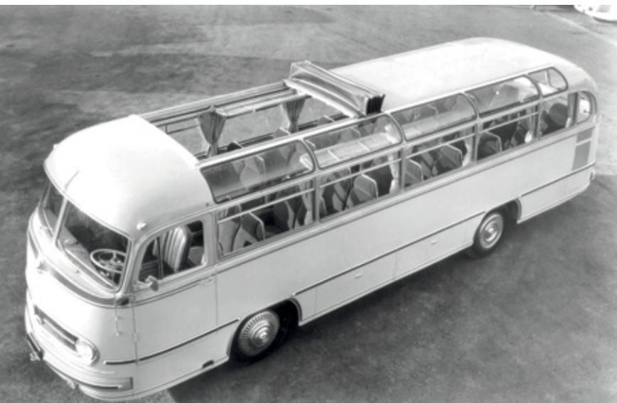
Dall'alto, un O 321 HL (passo lungo) in configurazione turistica con l'ampio bagagliaio permesso dal motore montato posteriormente.
